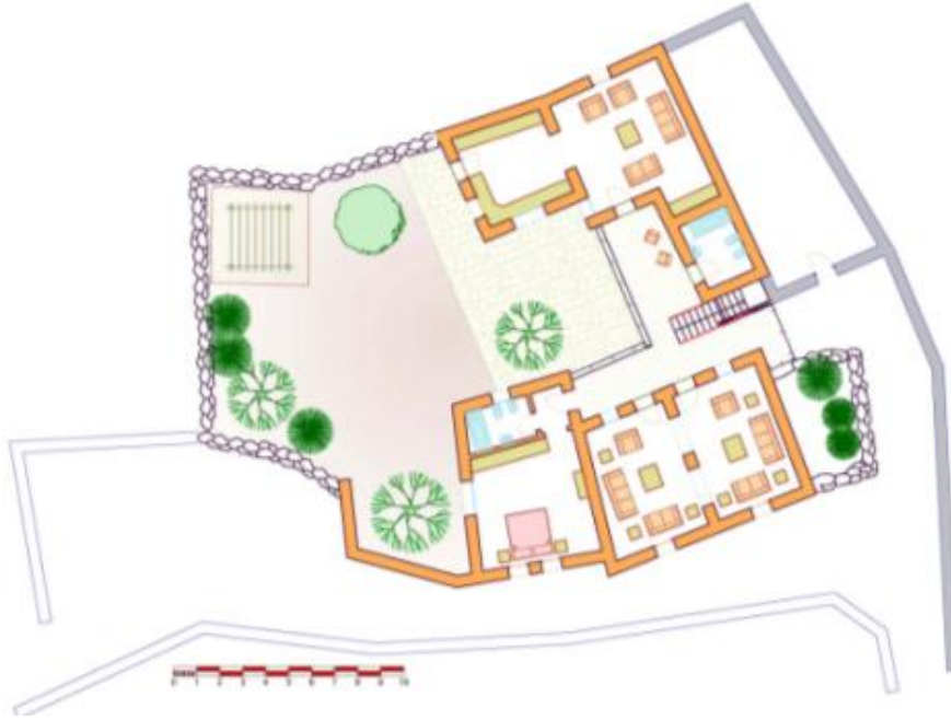
الشكل (5-122): مخطط الطابق الأرضي من الحوش السابق حسب الوضع المقترح وتم دمج الأقبية قليلة الارتفاع في بيوت الراوية في هذا الحوش أما في البيوت الأخرى التي يسمح فيها وضع القبو وارتفاعه سيتم الإبقاء عليها والتعامل معها كمرافق تابعة للقسم العلوي - المصدر الباحثة.
