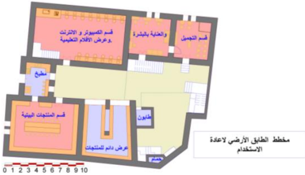
الشكل (5-51): مخطط الطابق الأرضي لإعادة استخدام دار الشيخ- المصدر: الباحثة
